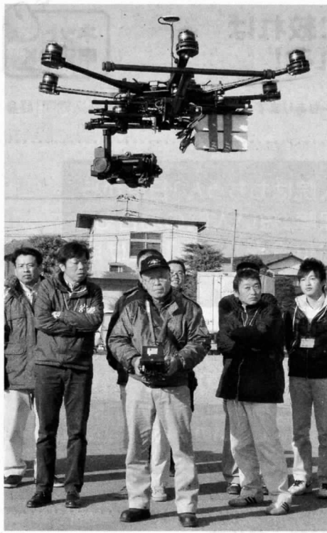
離陸した「マルチコプター」。下部に付けたカメラで街の様子を上空から撮影できる
